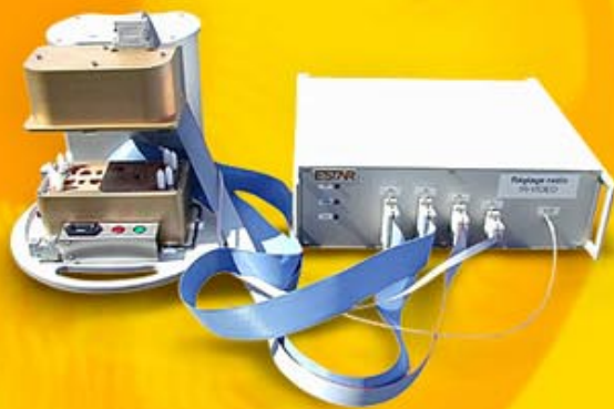
Banc de test radio intégré dans une ligne de fabrication de cartes électroniques ( système de contrôle )
